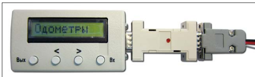
Рисунок 3. Подключение адаптера с насадкой к программатору
