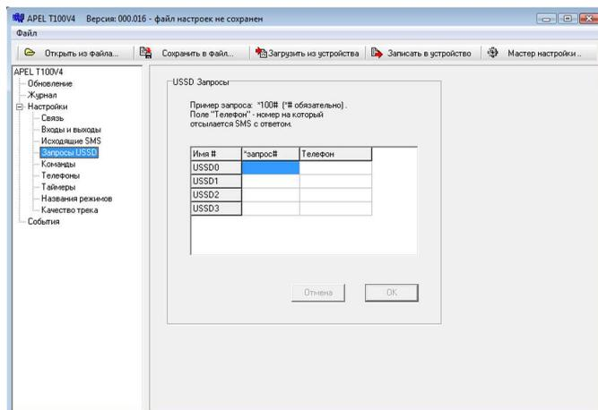
Можно определить 4 различных запроса. При выполнении запроса его ответ высылается в виде SMS на указанный телефон. Для запуска выполнения USSB запроса используются действия USSD0...USSD3. В поле "\*запрос#" указывается текст запроса вместе со звездочкой и решеткой, в поле телефон указывается номер телефона на который отсылается SMS с результатом.
