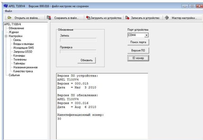
"Версия ПО" - выводит версию прошивки прибора и программы настройки.
