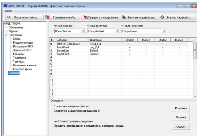
Во время работы прибора возникают различные события, например, появление фронта сигнала на одном из входов, соединение с сервером и т.д. Каждое событие проверяется обработчиком событий. Обработчик просматривает таблицу событий, найдя событие в списке запрограммированных проверяет текущий режим, и если режим совпадает - выполняет присвоенное событию действие. Событие может быть занесено в таблицу несколько раз, но с разными действиями.
