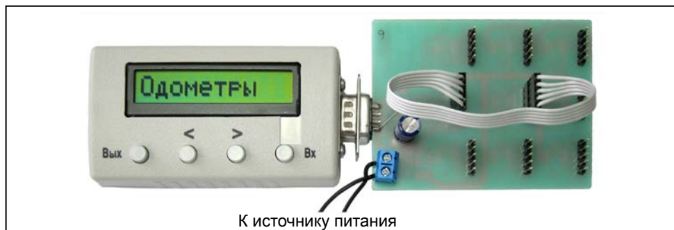
Рисунок 2. Подключение адаптера ПО5-EEPROM к программатору
