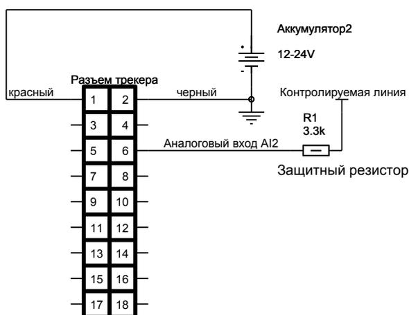
Рисунок 5: Использование защитного резистора для совмещенных входов
