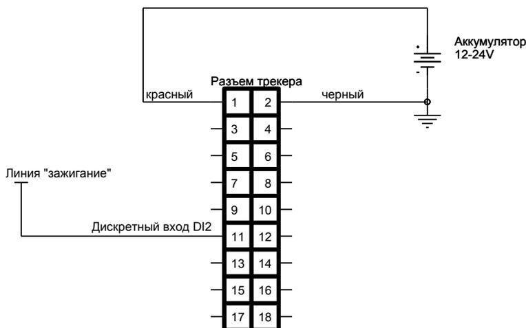
Рисунок 6: Пример подключение зажигания к дискретному входу DI2
