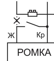
Двухпроводная схема включения регулятора
