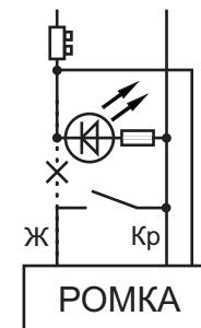
Отключить светодиод подсветки выключателя от клеммы желтого провода и подключить к черному проводу регулятора
