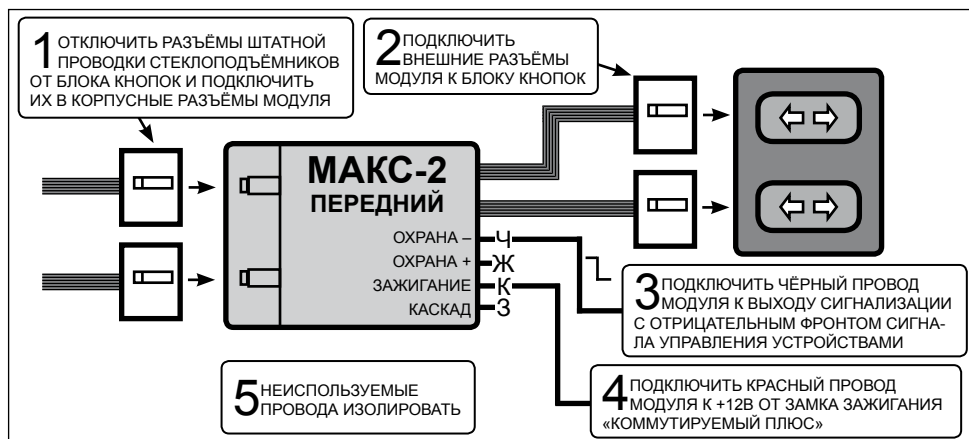
Рисунок 2. Схема подключения модуля МАКС-2 к сигнализации с отрицательным фронтом на выходе управления внешними устройствами
