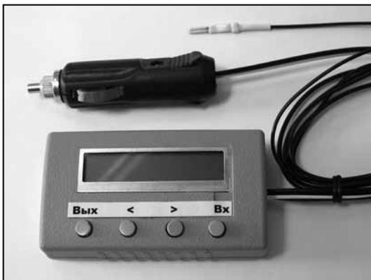
Рисунок 1. Тестер диагностический ДТ-1.
