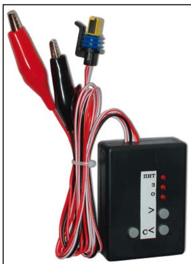
Рисунок 1. Тестер PXX. Общий вид.
