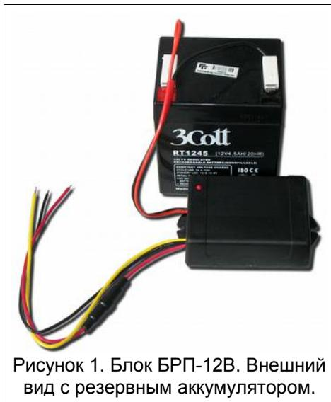
Рисунок 1. Блок БРП-12В. Внешний вид с резервным аккумулятором.
