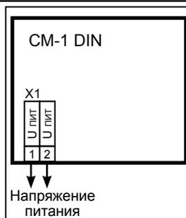
Рисунок 2. Счётчик моточасов СМ-1 DIN.
