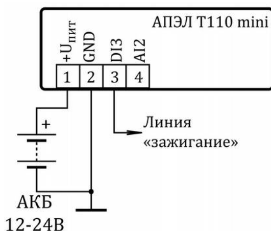
Рисунок 4: Пример подключение зажигания к дискретному входу DI3
