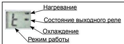
Рисунок 4. Отображение параметров в левой части индикатора регулятора
