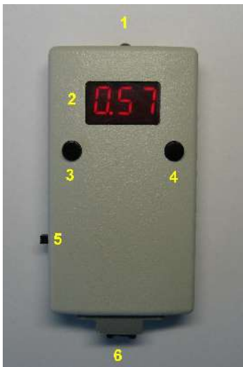
Рисунок 1: Индикатор толщины ИТ-01. Общий вид.
